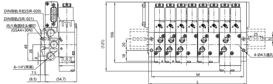
\* DIN导轨两端开孔位置无法指定, 随机变化
